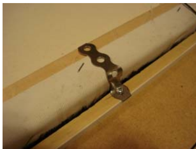
Morceau de bande galvanisée, généralement utilisée en plomberie, se coupe facilement avec des pinces et adopte aisément la forme voulue.
