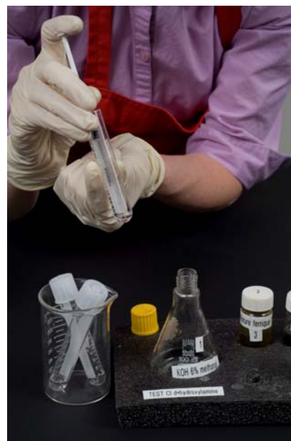
Les réactifs sont ajoutés à la fois dans l'éprouvette de référence, dans celle du blanc et dans celle de l'échantillon.
