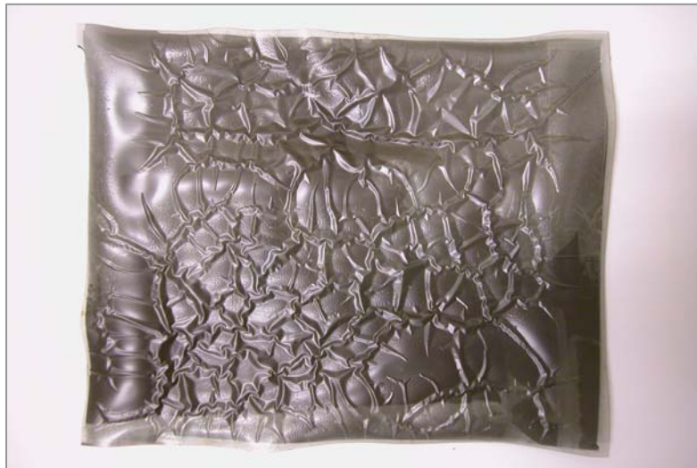
Négatif en acétate de cellulose en phase 5 de destruction. Le négatif est déformé, et des réseaux sont apparus, indiquant la réticulation et la désolidarisation de la pellicule gélatino-argentique et du substrat
