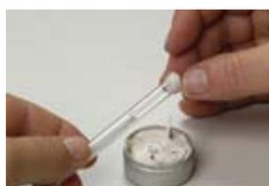
Mouiller le papier test dans de l'eau déionisée, l'insérer dans la pipette. Bien boucher l'ouverture à l'aide de pâte à modeler.
