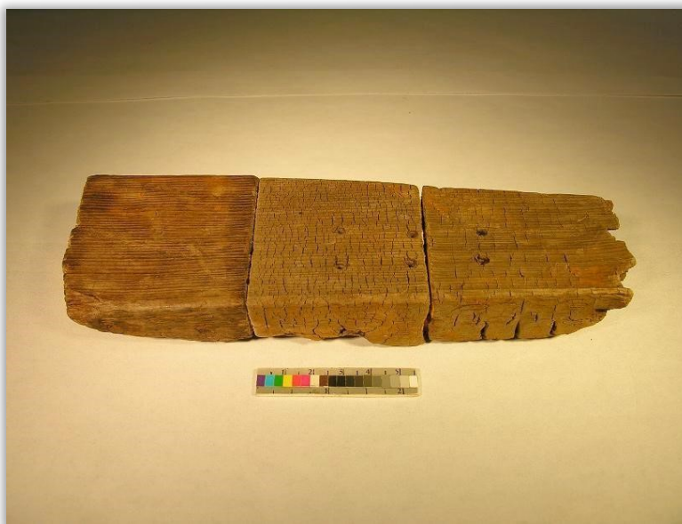
Figure 4 : Une pièce de bois, coupée en trois morceaux et traitée selon trois approches différentes. La partie de droite a été séchée à température ambiante, celle du centre a été lyophilisée sans PEG, et celle de gauche a été lyophilisée avec un pré-traitement au PEG. Remarquez la différence dans l'apparence et la structure du bois entre les trois échantillons. Les deux sections sans PEG ont développé des craquelures qui modifient l'apparence du bois, alors que pour la section traitée avec du PEG, elles sont presque absentes. Photographie d'André Bergeron, Centre de conservation du Québec.
